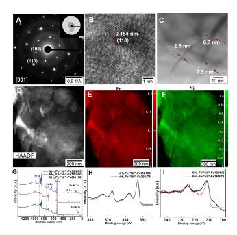
Figure 4. A) SAED pattern, B) HRTEM image, C), D) STEM images of NH<sub>3</sub>-Fe<sup>2+</sup>Ni<sup>2+</sup>-Fe25Ni75. Multivariate statistical analysis for E) Fe and F) Ni. G) XPS survey spectra, H) Ni 2p spectra, and I) Fe 2p spectra.
